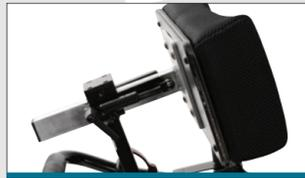
Die Kopfstütze passt sich den Kopfbewegungen des Nutzers an und dämpft diese gleichzeitig durch Gasdruckfedern ab, während die ursprüngliche Einstellung der Höhen- und Tiefenposition der Kopfstütze beibehalten wird.
