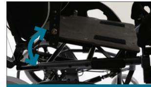
Die Sitzeinheit fügt sich der Veränderung der Hüfte während der Ausdehnungsphase. Dies verhindert das Rutschen und ungewolltes Verändern der Sitzposition. Das Netti | Dynamic System wird mit einer Führungsschiene für den Hüftgurt ausgeliefert. Um eine optimale Stabilisierung des Nutzers zu gewährleisten, ist das System mit einer 2-Punkte Hüftstabilisator ausgestattet.
