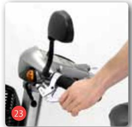
Das Parken und Feststellen der Bremse erfolgt durch Verriegeln des Antriebs. Dazu ist der Scooter durch eine Hilfsperson und/oder durch den Einsatz der manuellen Betriebsbremse zum Stehen zu bringen. Anschließend ist die elektro-magnetische Bremse, wie in Abbildung 22 dargestellt zu betätigen.
