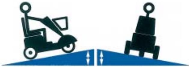
Maximale Steigung: 10°    Maximale Neigung: 6°
