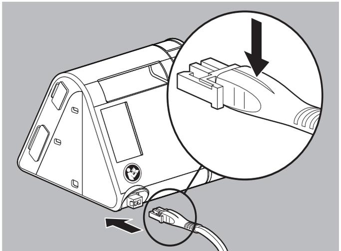
2. Freier Stecker der Verbindungsleitung des Netzteils in den Anschluss für Stromversorgung am Therapiegerät stecken. Dabei auf die Ausrichtung des Steckers achten.
