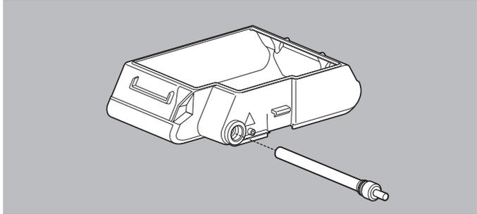
1. Heizstab aus dem Befeuchterunterteil schrauben.
