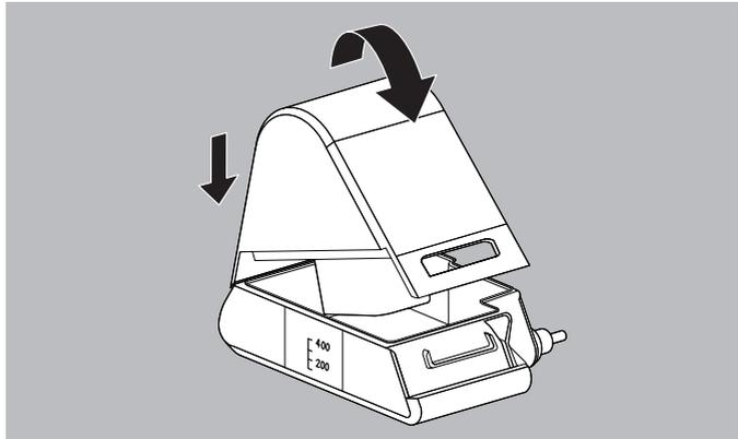
10. Befeuchteroberteil von hinten auf das Befeuchterunterteil setzen und leicht andrücken bis es einrastet.
