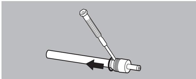
2. Dichtring mit einem Schraubendreher vorsichtig abnehmen, ohne die Nut zu beschädigen.
