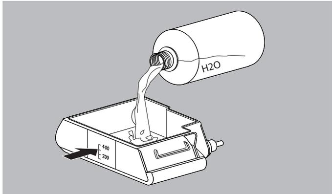
5. Befeuchterunterteil bis zur Markierung (max. 400 ml) mit frischem, kaltem Wasser füllen.
