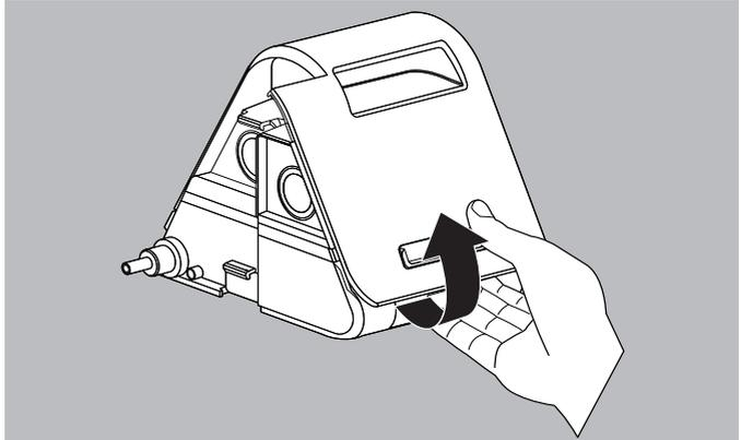
3. Um den Atemluftbefeuchter zu öffnen, an der Gehäuserückseite in die untere Griffmulde fassen und mit dem Daumen leicht auf die Gehäuserückseite drücken.
