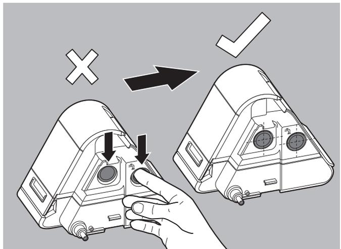
11. Darauf achten, dass sich die Eingangs- und Ausgangsöffnung des Befeuchtereinsatzes genau in die Öffnungen des Befeuchteroberteils schieben. Wenn nötig: Mit den Fingern in die Öffnungen fassen und nachjustieren
