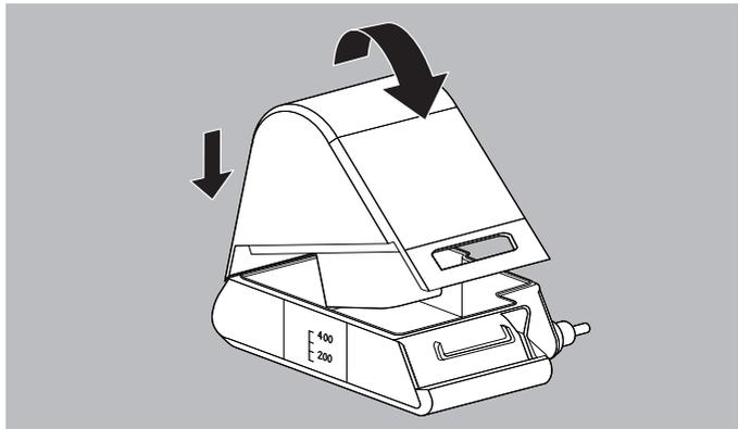
6. Befeuchteroberteil von hinten auf das Befeuchterunterteil setzen und leicht andrücken bis es einrastet.
