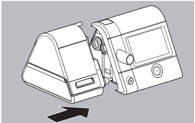
3. Atemluftbefeuchter auf einer ebenen Fläche seitlich in das Therapiegerät schieben bis die Entriegelungstaste hörbar einrastet.
